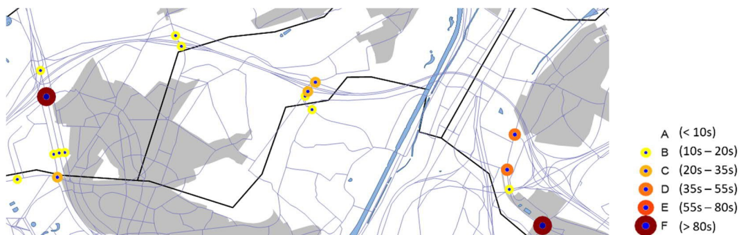
Figure 63 : Analyse LOS alternative G3A2, zone de Vilvorde (en haut : HPM, en bas : HPS)
