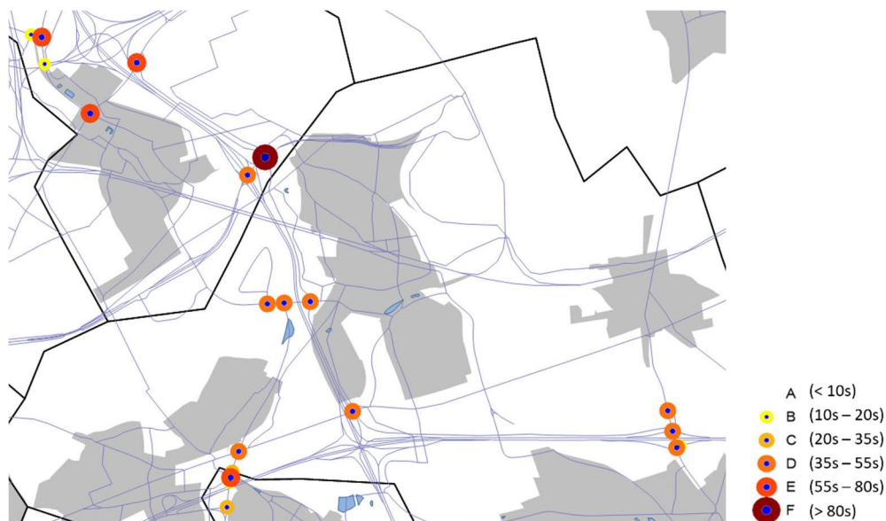
Figure 74 : Analyse de la LOS - alternative G3A3, zone Zaventem - HPS
