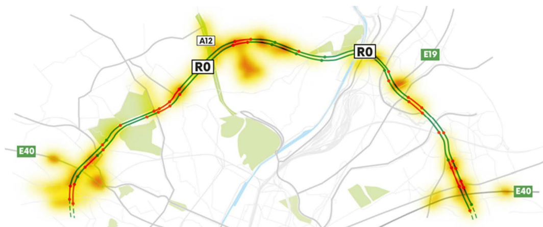
Figure 22 : Carte thermique des accidents de la circulation avec l'analyse des discontinuités et des longueurs de turbulence de la situation existante sur le DRW (120 km/h)
