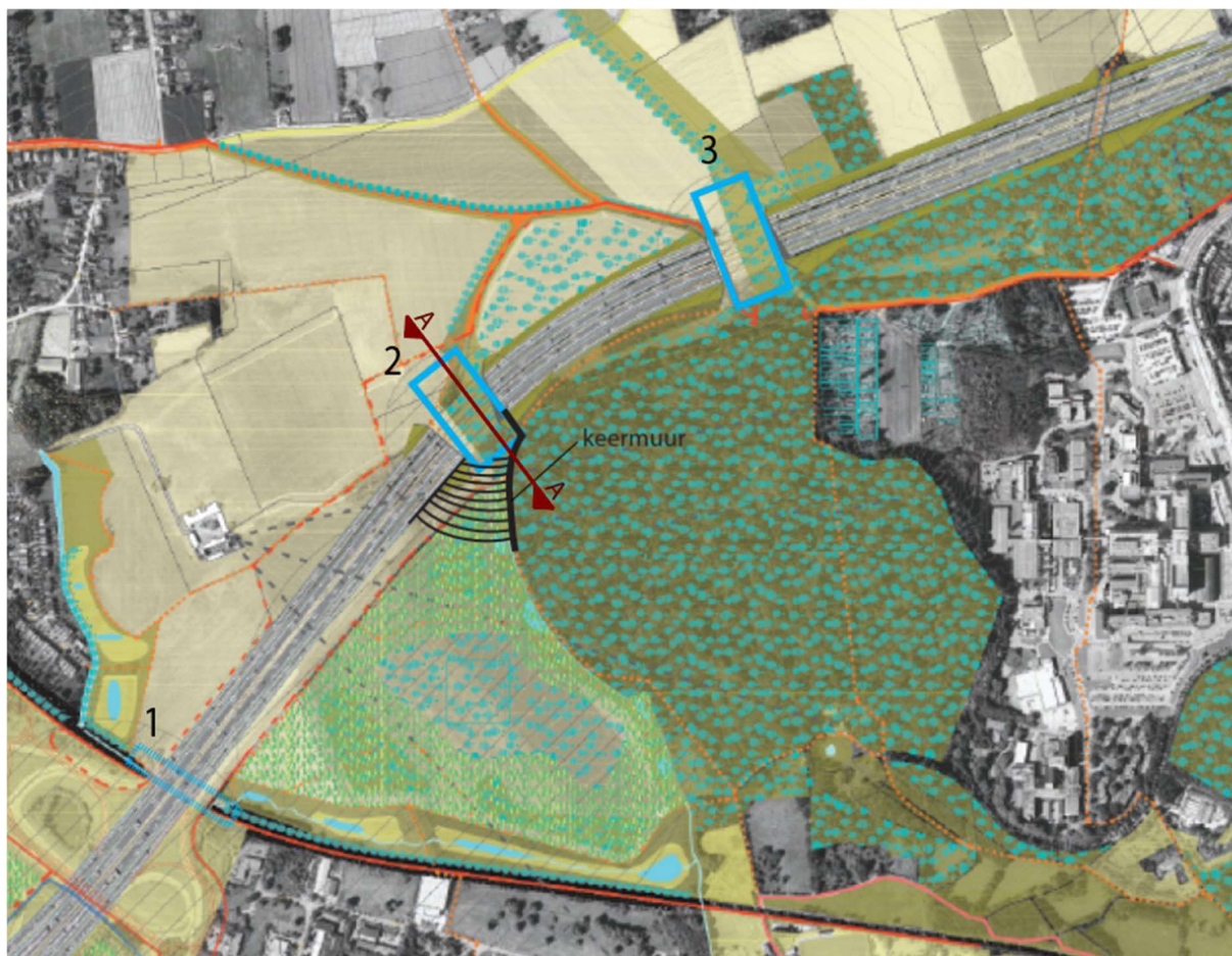
Figure 34 : Alternatives de base du plan directeur avec 2 ponts paysagers Cycle 1 (THV MoVeR0) avec emplacement des écopassages
