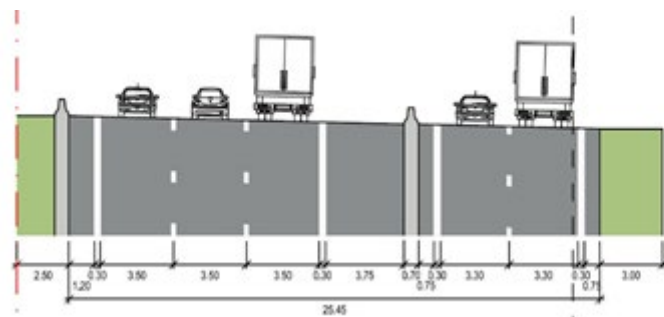
Figure 16 : Principe du profil G2 - Cycle 2 : avec une seule voie et une séparation physique entre les RC et RU.
