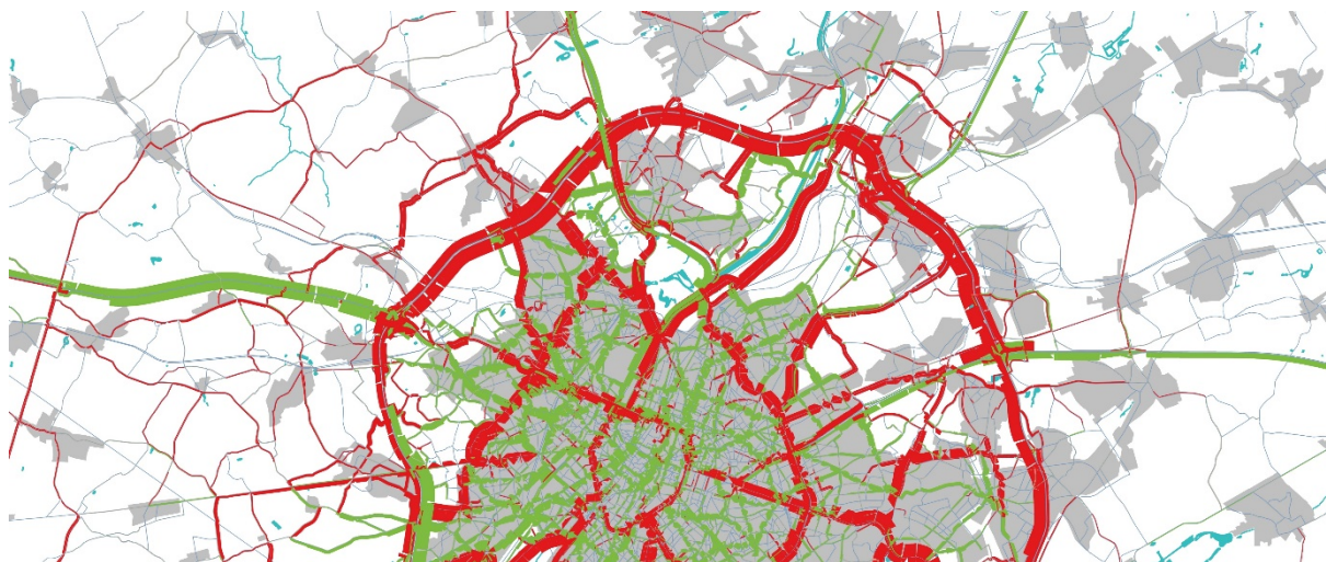
Figure 133 : Graphique des différences heure de pointe du matin - G2A1 Cycle 1 avec RMA et 5 km/h, comparé à G2A1 avec RMA (Source : MTR RND v4.2.1)
