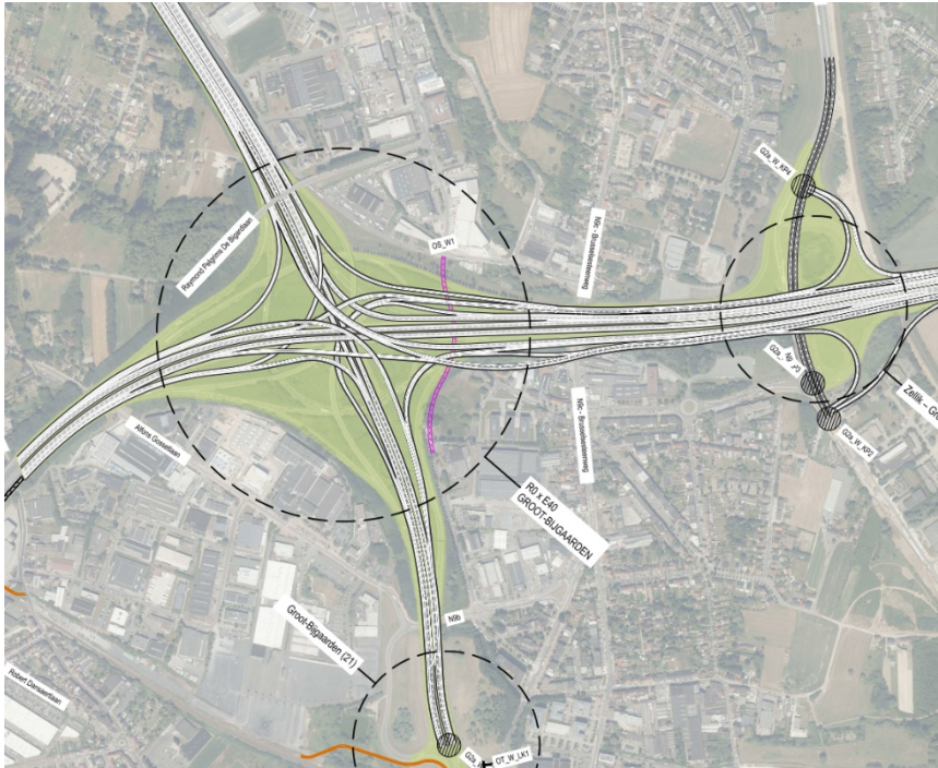
Figure 60 : échangeur /nœud E40 Grand-Bigard variante a dans G2 - Cycle 2 → variante avec nœud 4/4 RU et RC
