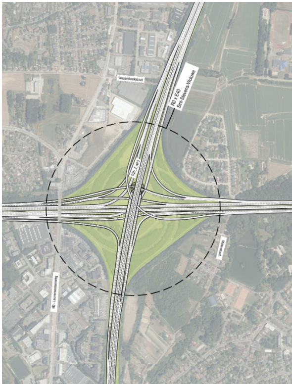
Figure 71 : échangeur R0/E40 Woluwe-Saint-Étienne variante b dans G2 - Cycle 2 → nœud en étoile 3/4 RU
