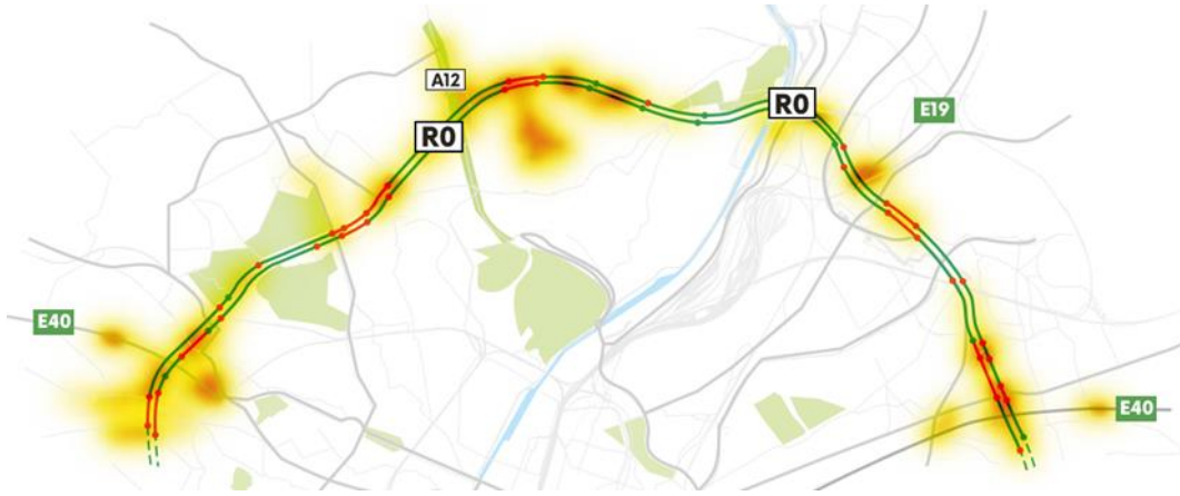
Figure 22 : Heatmap des accidents de la circulation avec l'analyse des discontinuités et des longueurs de turbulence de la situation existante sur le RC (120 km/h)
