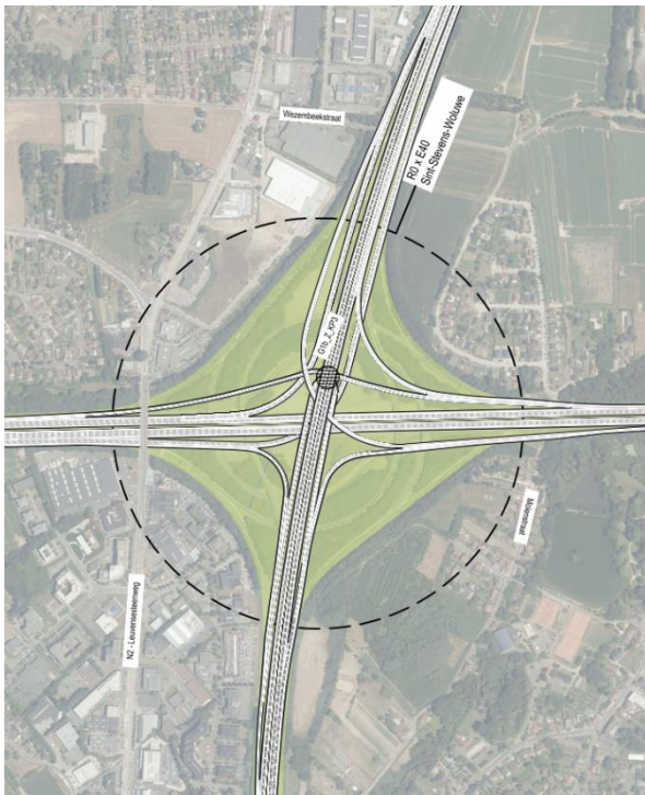
Figure 59 : échangeur /nœud E40 Woluwe-Saint-Étienne variante b dans G1 - cycle 2 → un nœud en étoile 3/4
