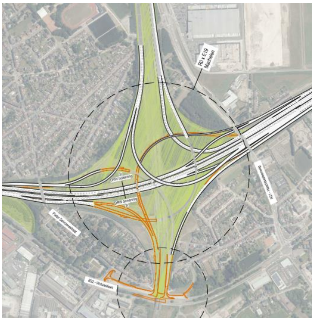
Figure 68 : échangeur /nœud E19 Machelen dans G2 - cycle 2 → un nœud en étoile 4/4 RU
