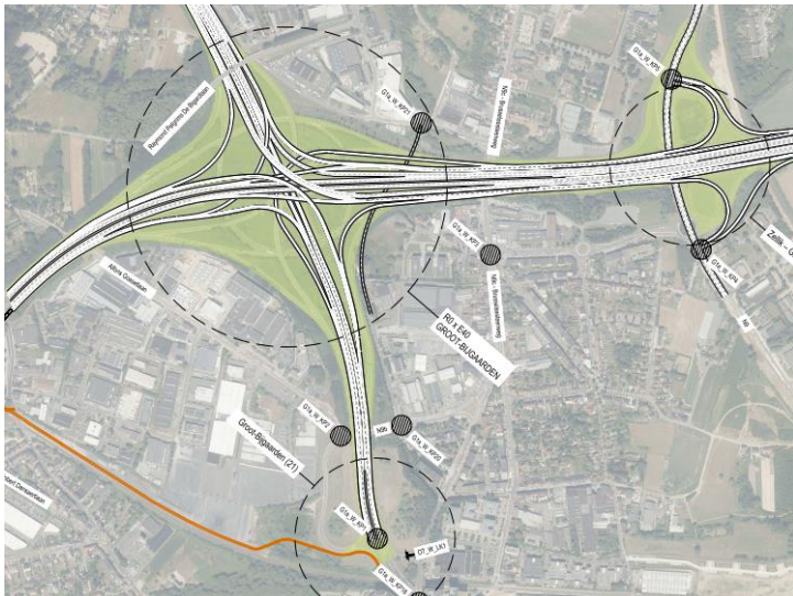
Figure 50 : échangeur /nœud E40 Grand-Bigard dans G1a - Cycle 2 → variante nœud en étoile 4/4
