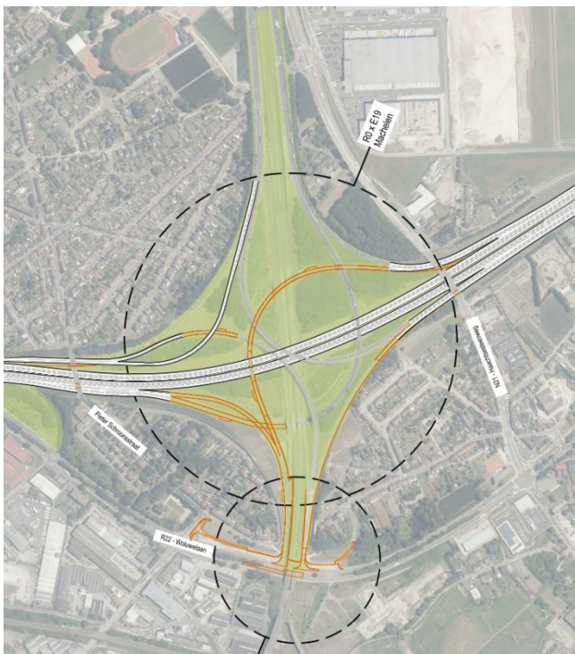
Figure 56 : échangeur /nœud E19 Machelen dans G1 - Cycle 2 → un nœud en étoile 4/4
