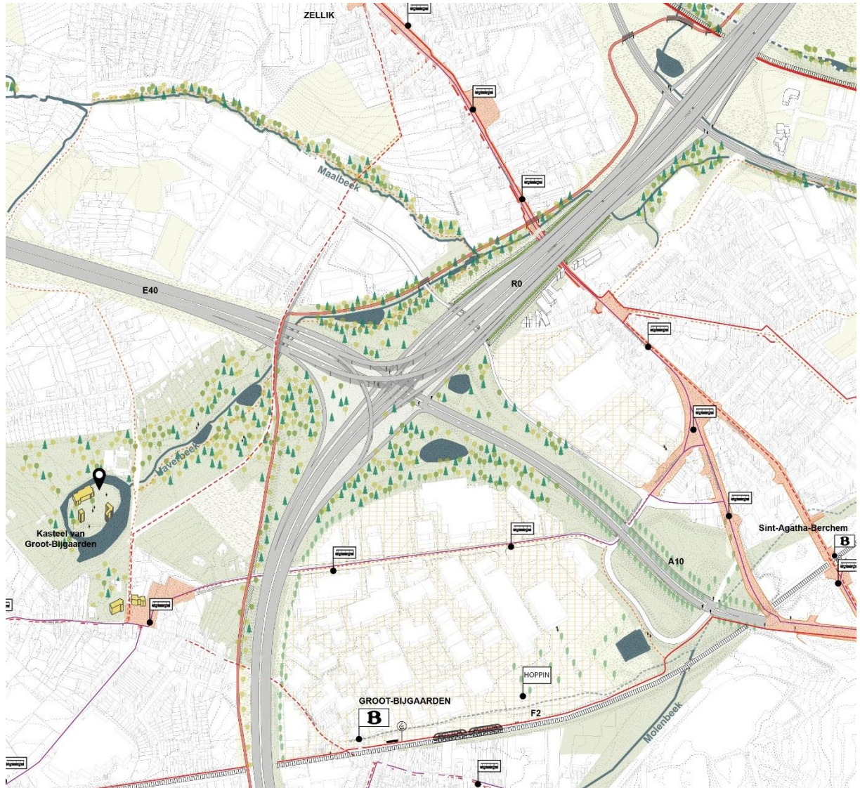
Figure 80 : Développement spatial du CR 10 comme complexe hollandais dans le cas d'un noeud 3/4 – Cycle 2
