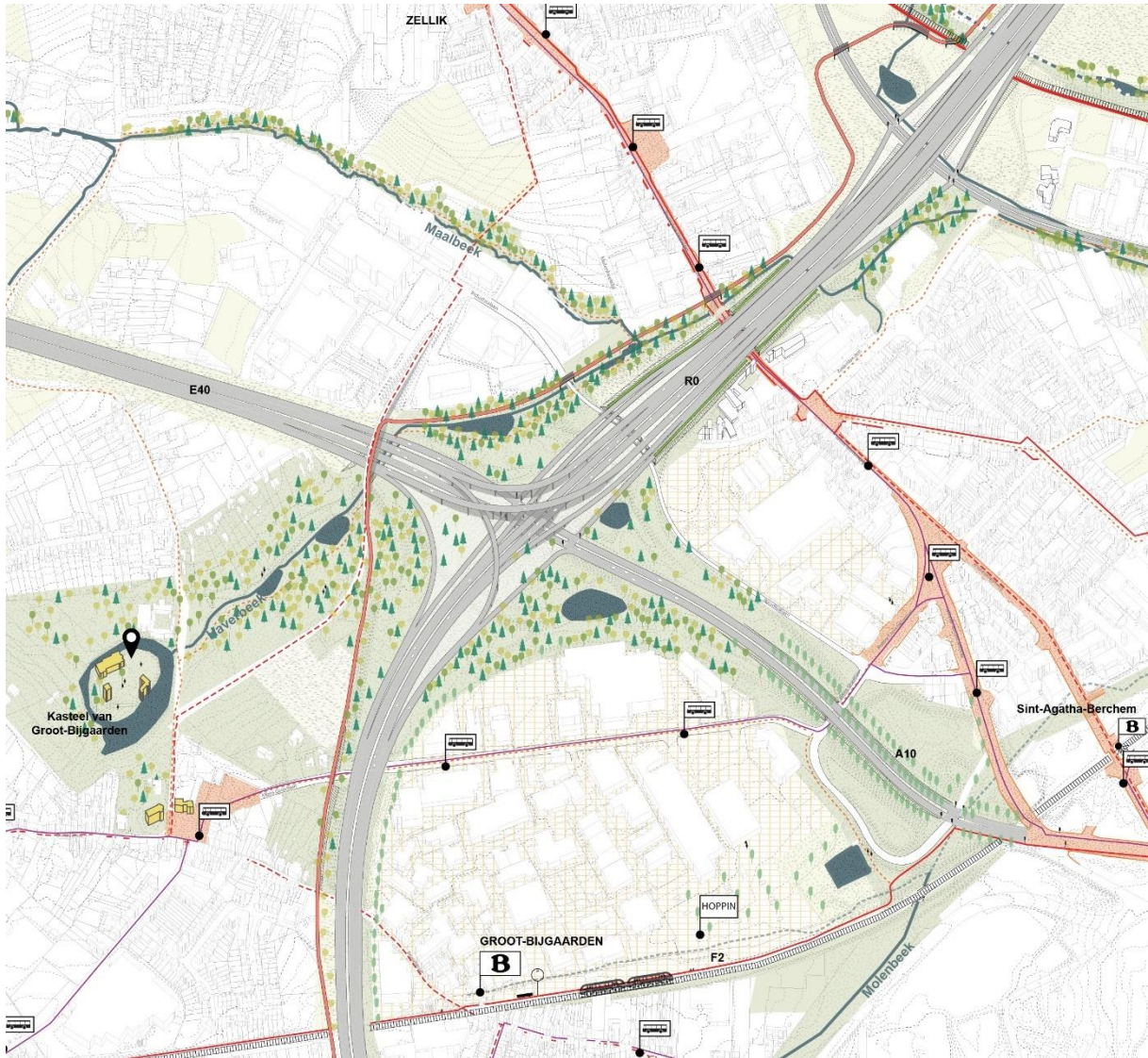
Figure 136 : Échangeur R0/E40 Grand-Bigard, variante Alt 2b (Cycle 2)
