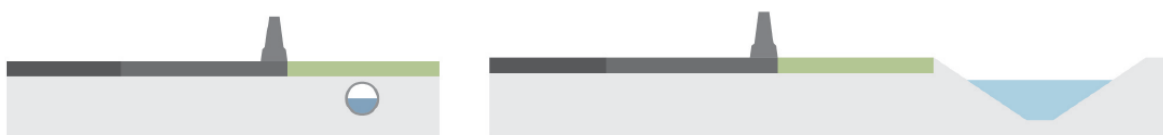
Figure 107 : Représentation schématique de la conduite d'eau (figure de gauche) et du fossé de drainage (figure de droite)
