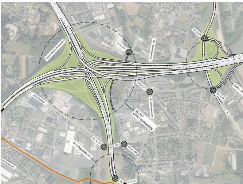
Figure 61 : échangeur /nœud E40 Grand-Bigard variante a dans G2 - Cycle 2 → variante avec nœud 4/4 RU et RC
