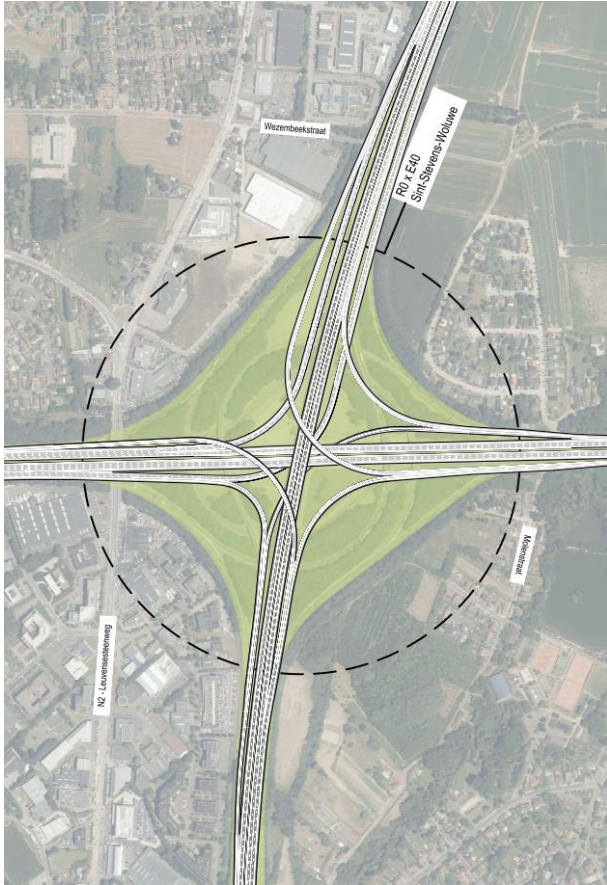
Figure 58 : échangeur /nœud E40 Woluwe-Saint-Étienne dans G1 - cycle 2 → un nœud en étoile 4/4
