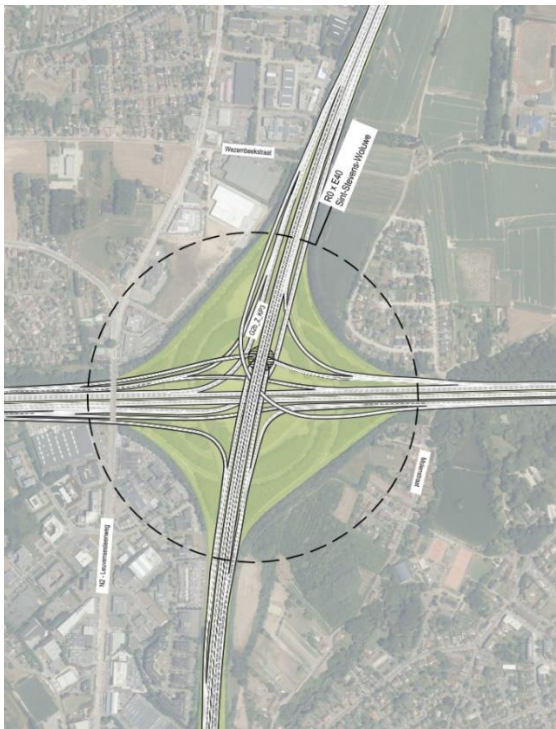
Figure 72 : échangeur R0/E40 Woluwe-Saint-Étienne variante b dans G2 - Cycle 2 → nœud en étoile 3/4 RU
