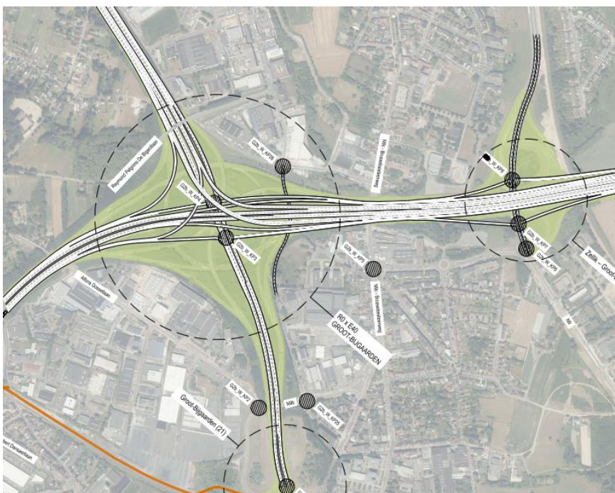
Figure 63 : échangeur /nœud E40 Grand-Bigard variante b dans G2 - Cycle 2 → variante avec nœud 3/4 RU
