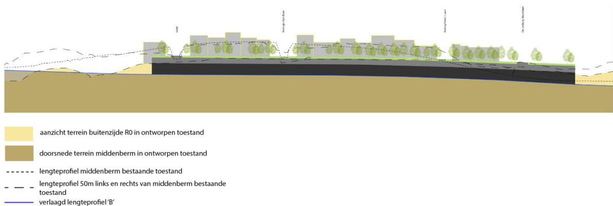
Figure 39 : Profil longitudinal abaissé avec pont maximal, zone de Wemmel-Jette - Cycle 2 (LPb_WM2) - le profil longitudinal est mis à l'échelle 5 fois par rapport à la hauteur (axe Y).
