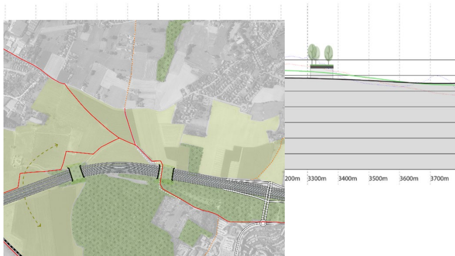
Figure 36 : Coupe longitudinale des ponts paysagers à la hauteur du Bois du Laerbeek
