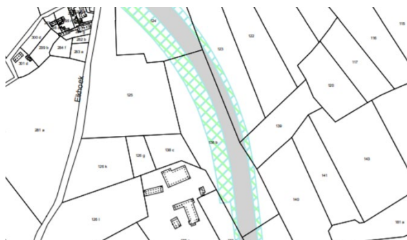
Figure 103 : Exemple d'une partie d'un plan de zonage dans lequel une zone est désignée pour une infrastructure routière en fonction d'une nouvelle infrastructure (zone grise). Parallèlement, une zone en surimpression sera prévue pour l'intégration paysagère et fonctionnelle de l'infrastructure routière (voir l'explication au point 3.2.2. Exemples de destinations en surimpression).
