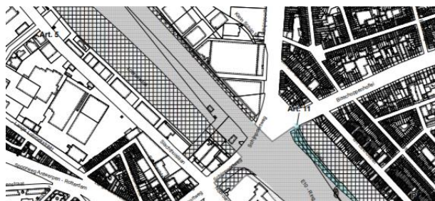
Figure 108 : Exemple d'une partie d'un plan de zonage où, outre la zone de l'infrastructure routière, les zones de chantier sont également indiquées en surimpression.
