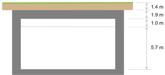
Figuur 135: Illustratie principiële ruimtereservering in dwarssectie
