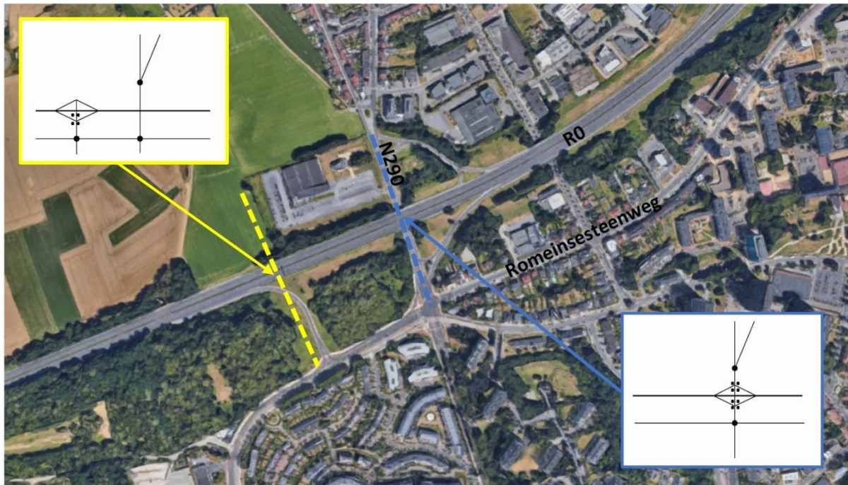
Figuur 141: Schematische weergave asverschuiving aansluitingscomplex N290 (blauw basis as aansluitingscomplex N290 - geel variant as-verschuiving van het aansluitingscomplex)
