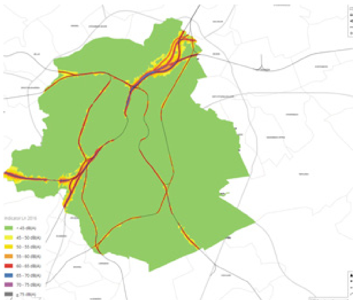
Figuur 6-13: Geluidsbelastingskaart spoorverkeer Ln in de omgeving van het plangebied – referentiejaar 2016 (bron: Leefmilieu Brussel).
