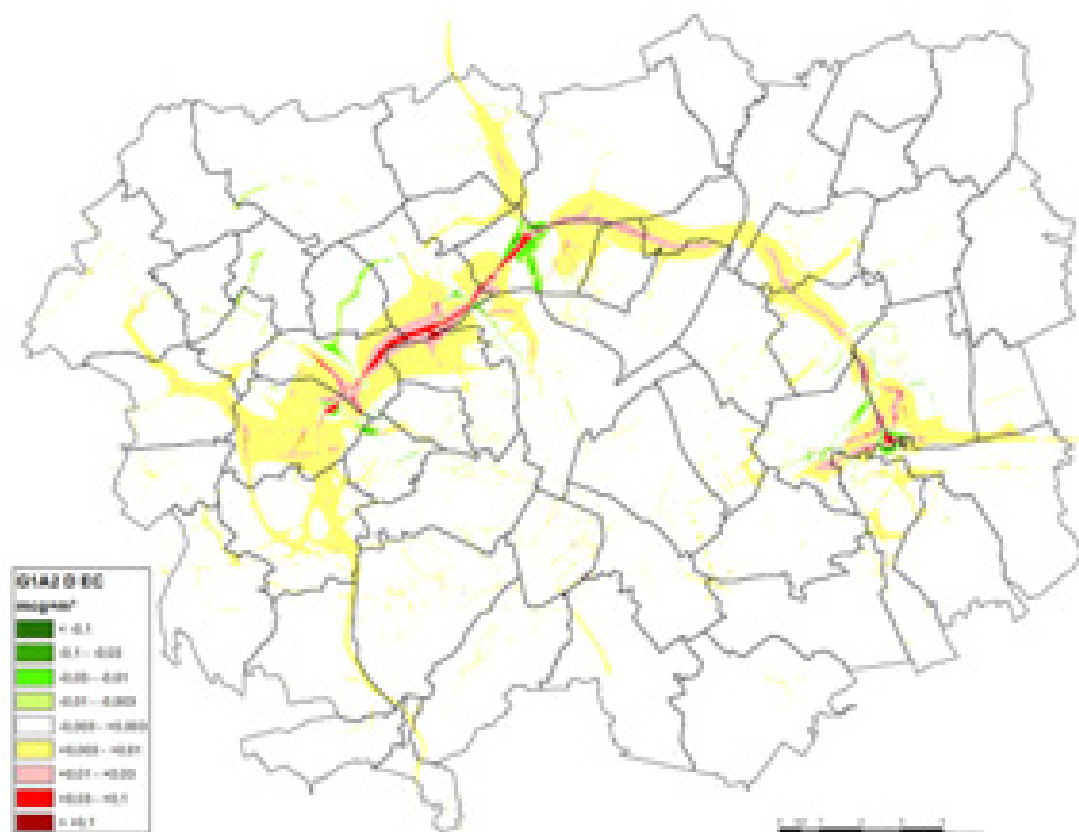
Figuur 5-24: Scenario G1A2 - EC jaargemiddelde – verschil met referentiescenario
