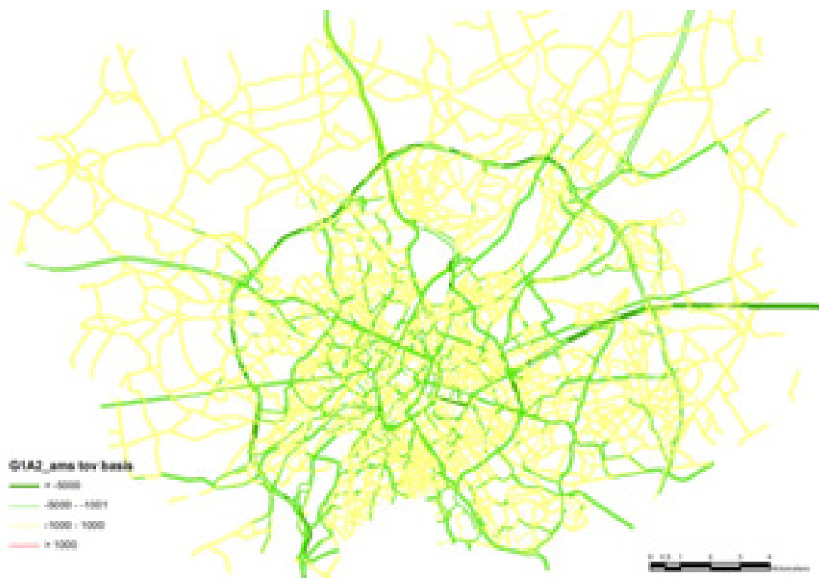
Figuur 5-50: (absoluut) verschil in "pae" (personen-auto-equiv) per wegsegment tussen G1A2_ams en G1A2
