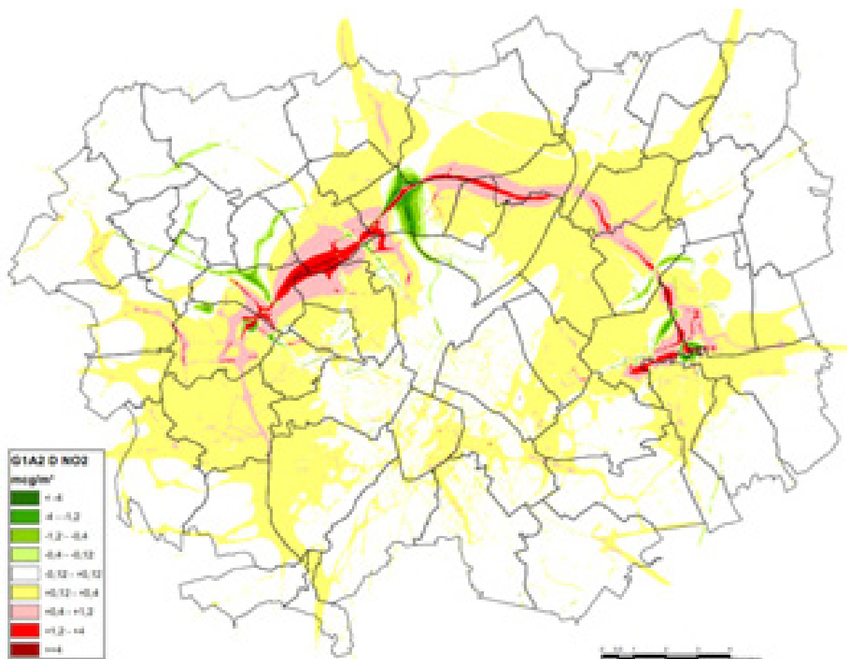
Figuur 5-19: Scenario G1A2 – NO 2 jaargemiddelde – verschil met referentiescenario
