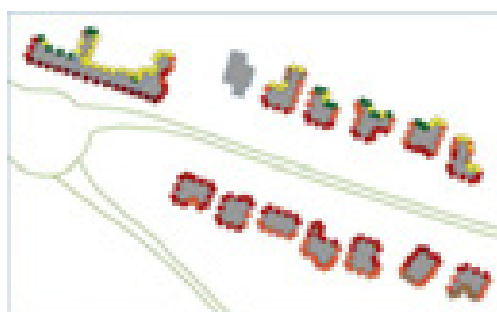
Figuur 6-3: Detail berekende gevelpunten rondom gebouwen ter bepaling van de gevelbelasting
