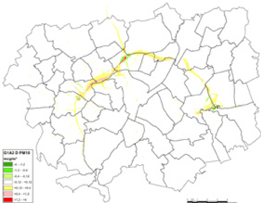
Figuur 5-21: Scenario G1A2 – PM10 jaargemiddelde – verschil met referentiescenario
