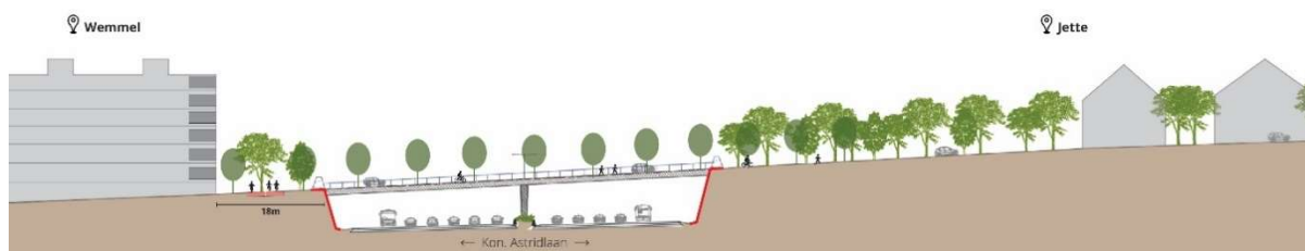
Figuur 262: G1A2 – Verlaagd lengteprofiel – K. Astridlaan
