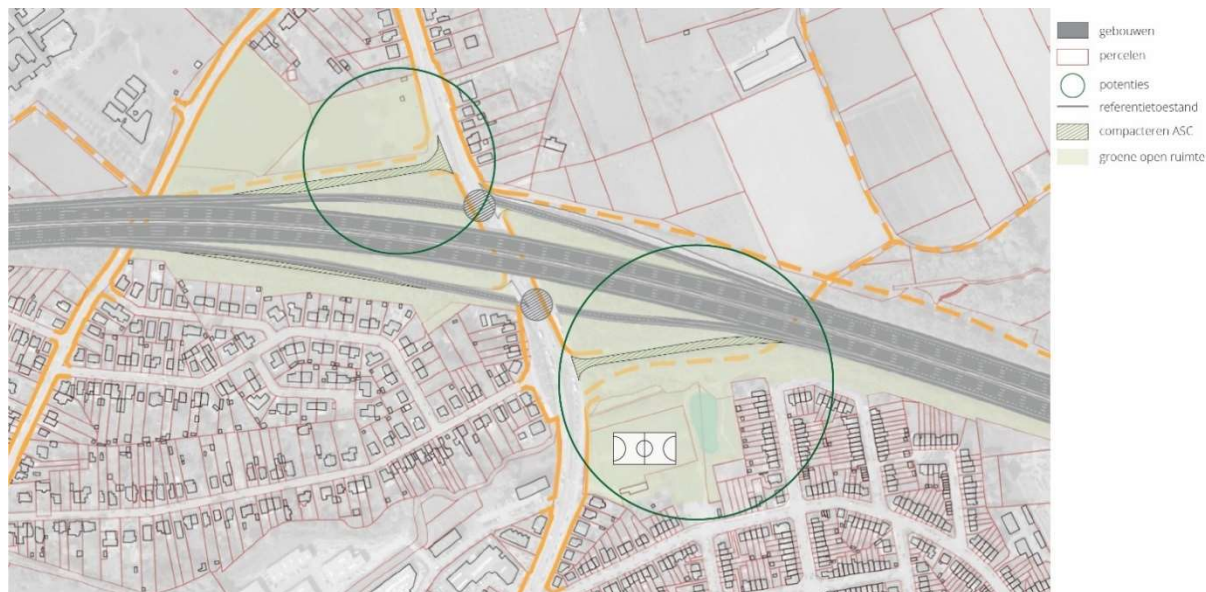
Figuur 287: Potentie compactere vormgeving aansluitingscomplex 7 (N202-Grimbergen)
