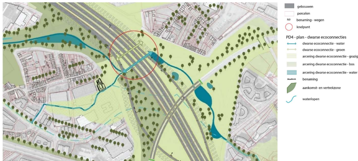
Figuur 357: Dwarse ecoconnectiviteit – versterking barrièrewerking door parallelle infrastructuur t.h.v. A201 (G2A1)
