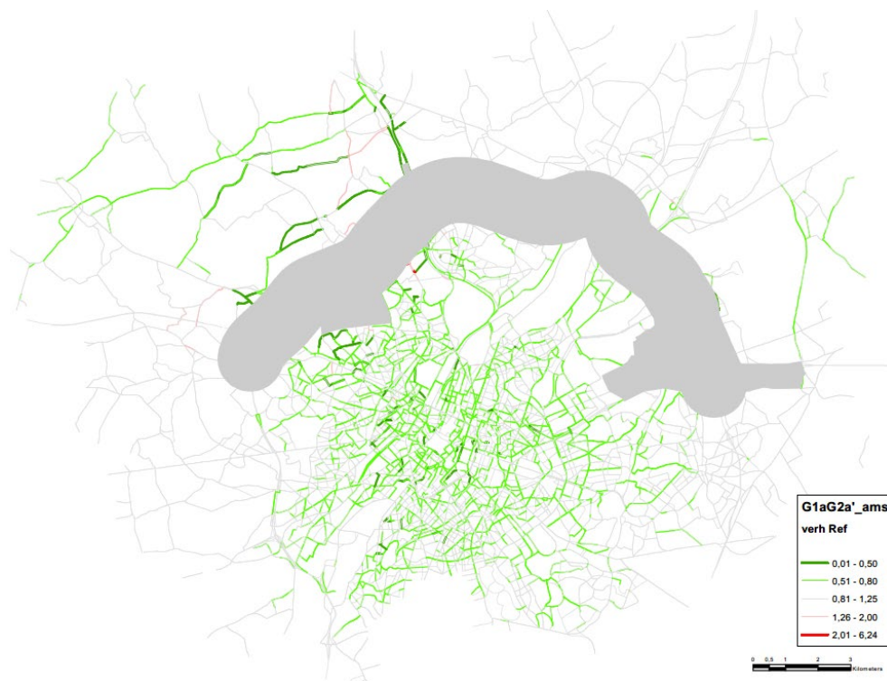
Figuur 7-35: Verhouding in verkeersintensiteit tussen G1aG2a'_sn en Ref buiten het rekengebied (grijs)
