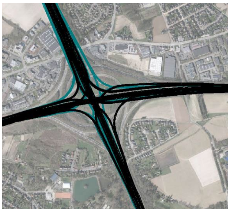
Figuur 11-198: Uitvoering weginfrastructuur ter hoogte van verkeerswisselaar Sint-Stevens-Woluwe in de 'parallel' systemen (bron: MoVeR0) (zwart = basisuitvoering 'light', groen = toevoeging parallelwegen)
