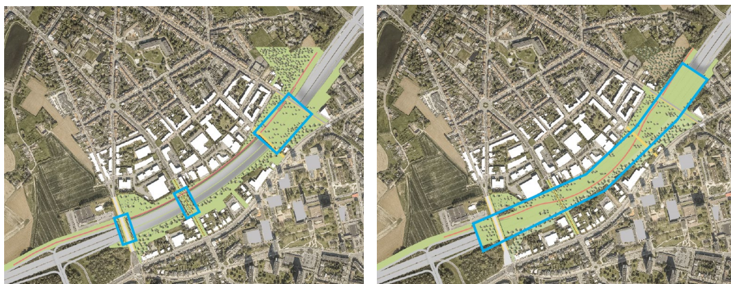
(links grotendeels open sleuf, rechts volledige intunneling)
