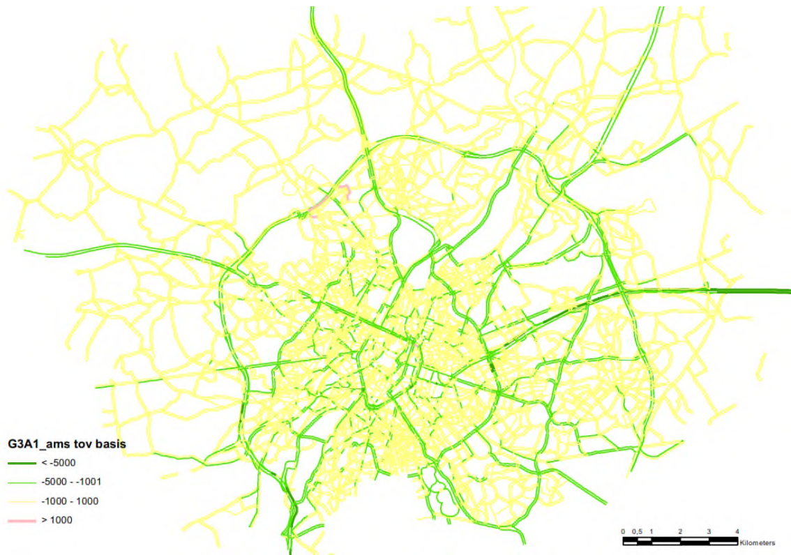
Figuur 3-19: (absoluut) verschil in “pae” (personen-auto-equiv) per wegsegment tussen G3A1_ams en G3A1
