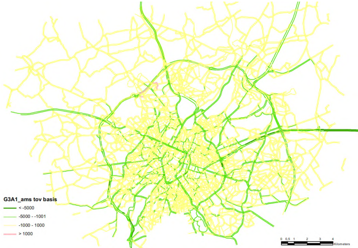
Figuur 5-52: (absoluut) verschil in “pae” (personen-auto-equiv) per wegsegment tussen G3A1_ams en G3A1
