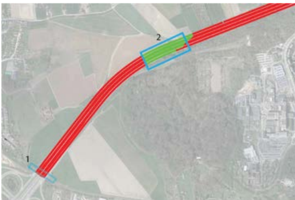
Figuur 38: Civil 3D-model met locatie ecopassages. Groen: verdiepte ligging t.o.v. omliggend maaiveld (10m)
