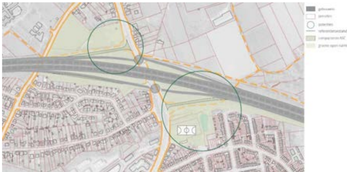
Figuur 287: Potentie compactere vormgeving aansluitingscomplex 7 (N202-Grimbergen)
