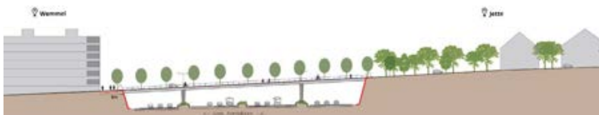
Figuur 265: Snede G2A1 – Verlaagd lengteprofiel – K. Astridlaan
