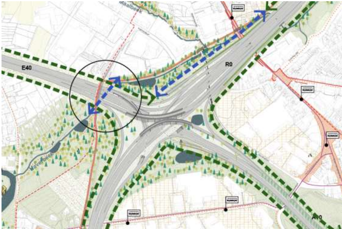
Figuur 303: Lange ecoconnectiviteit t.h.v Verkeerswisselaars R0/E40W – illustratie alternatief 1 variant a (Alt1-a)
