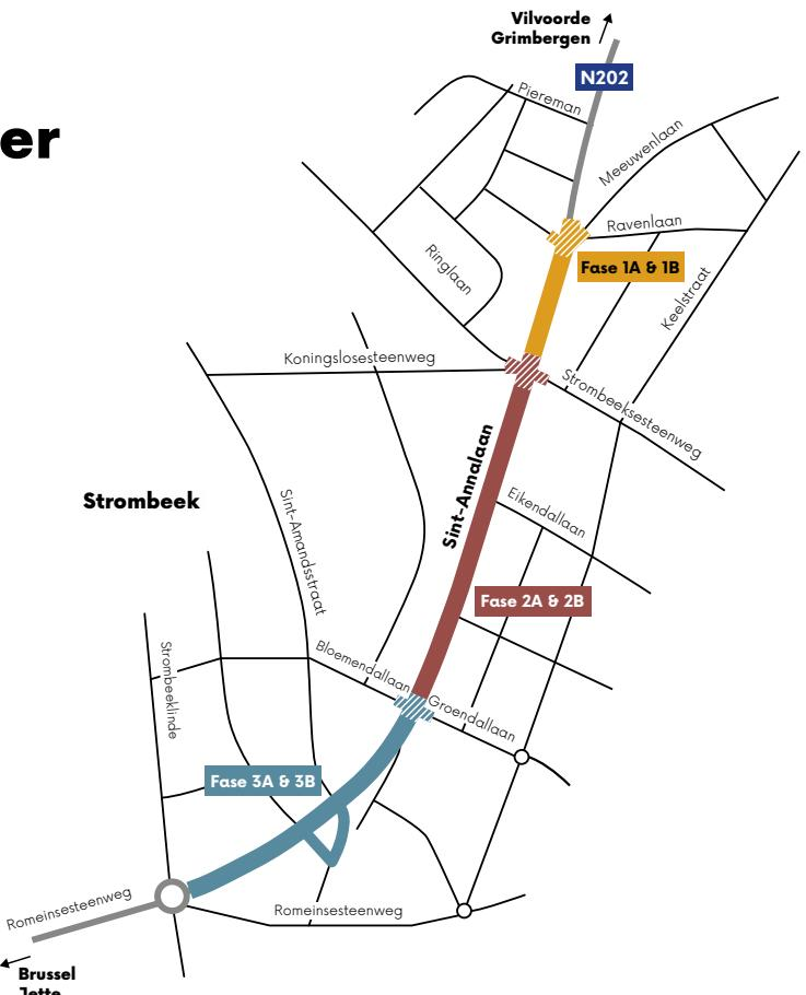
Elke fase is opgedeeld in twee deelfases. Het kruispunt in de werfzone vormt telkens deelfase A. De rest van de zone vormt deelfase B. Beide deelfases starten altijd tegelijk op, maar deelfase A (het kruispunt) is vroeger afgewerkt dan deelfase B. Door het kruispunt sneller open te stellen, zijn er meer verkeersbewegingen mogelijk voor het lokale verkeer.
