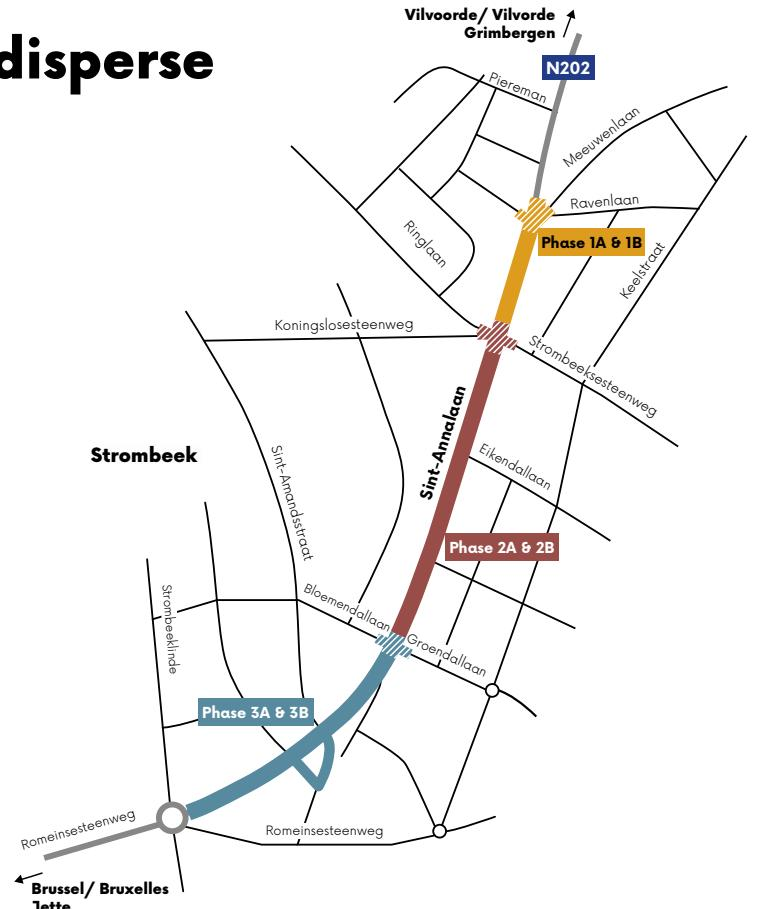
Chaque phase est divisée en deux sous-phases. L'intersection dans la zone de chantier forme toujours la sous-phase A. Le reste de la zone forme la sous-phase B. Les deux sous-phases commencent toujours en même temps, mais la sous-phase A (l'intersection) se termine plus tôt que la sous-phase B. En ouvrant l'intersection plus rapidement, le trafic local peut circuler davantage.
